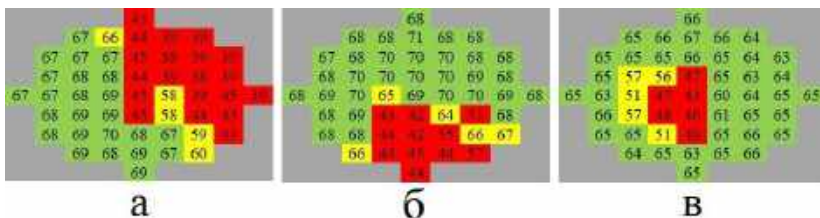
Рисунок 3 – Пример искажения вязкости по плоскости при поверхностном зондировании
